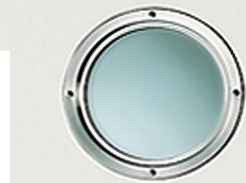
Joint intumescent: à base de graphite 15x2.5mm, en six couleurs, se dilatant dans une proportion de 25 fois sa taille à partir de 150 degrés.
